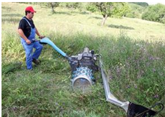
Figura 3. Demonstrație de utilizare a motocositoarei Sursa: http://www.fundatia-adept.org/
